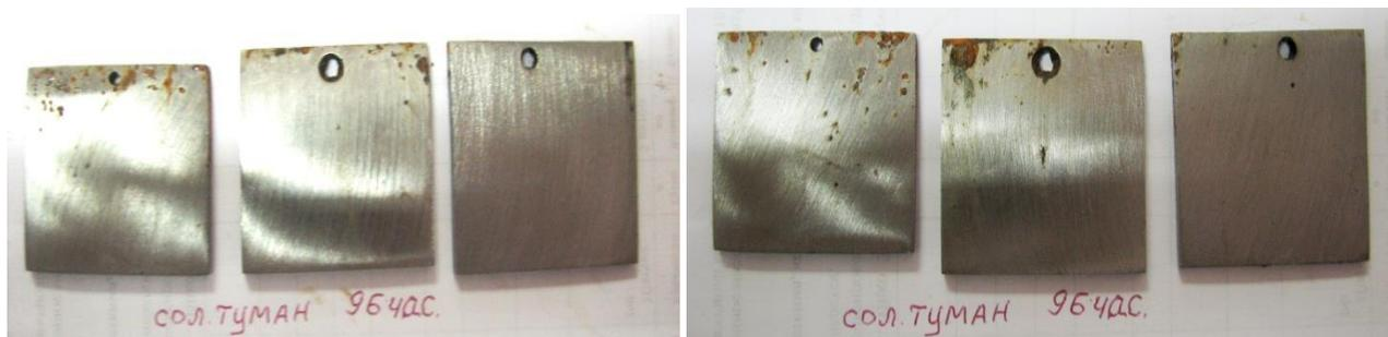
Внешний вид пластин после удаления масляной пленки после 96 часов в камере соляного тумана.
