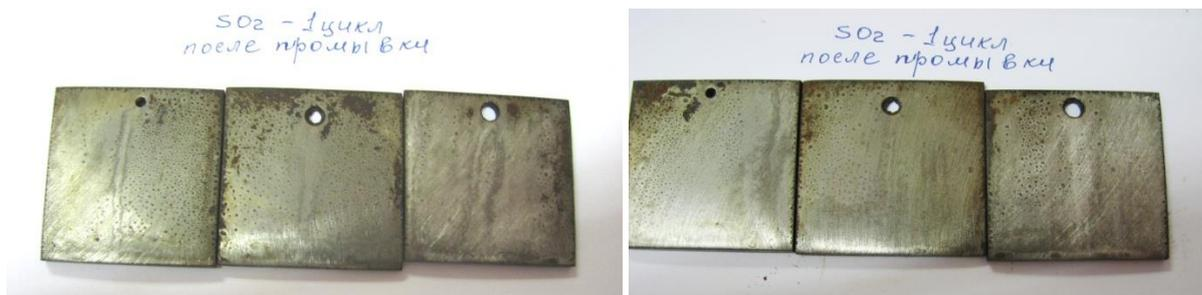
Внешний вид пластин после удаления масляной пленки после 1 цикла испытаний в камере сернистого ангидрида.
